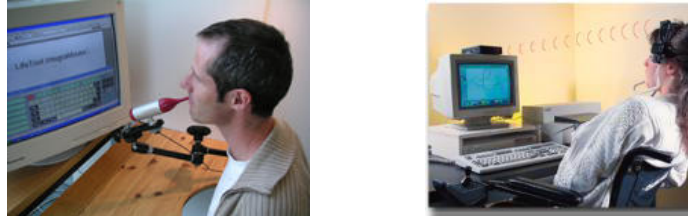
Figure 2. Deux exemples de dispositifs d'entrée. À gauche, détecteur de souffle. À droite, détecteur de mouvements de têtes
